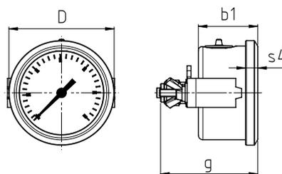
рекомендуемый размер отверстия при монтаже на щитах  $\varnothing 51 \pm 0,3$  мм
