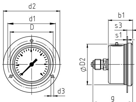
рекомендуемый размер отверстия при монтаже на щитах  $\varnothing 54 \pm 0,3$  мм
