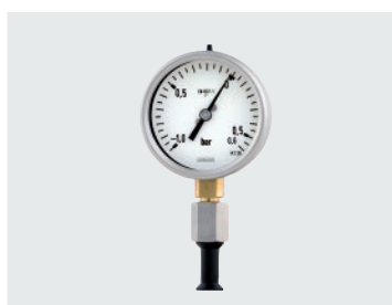
Манометр для контроля давления в консервных банках
